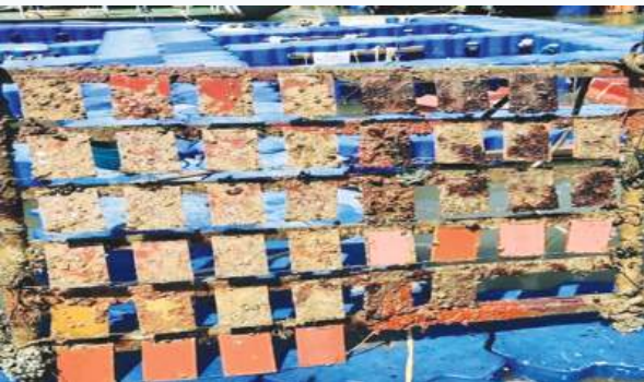
Mẫu sơn 3 lớp sau 12 tháng thử nghiệm (chưa loại bỏ sinh vật bám) (bên trái) và 18 tháng thử nghiệm (sau khi loại bỏ sinh vật bám) (bên phải).
